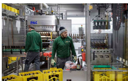
Der Einpacker in der Flaschenfüllerei kann über 6000 Flaschen pro Stunde in Harasse stellen.
